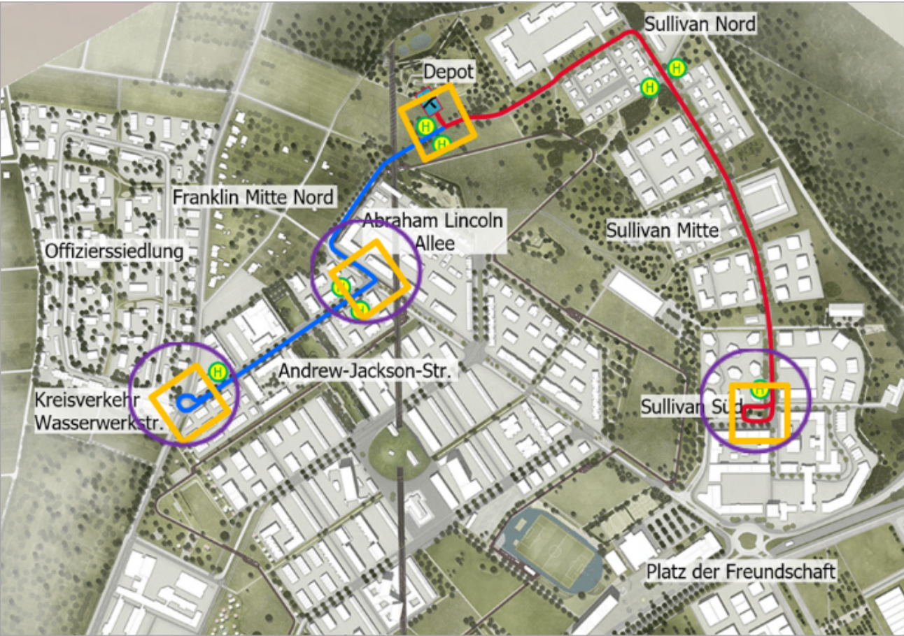
Abbildung 9: Haltestellen und Lichtsignalanlagen entlang der RABus-Route
