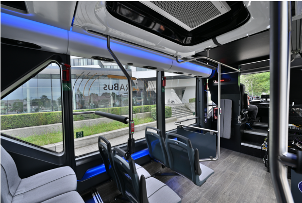
Länge x Breite x Höhe: 6,90 x 2,30 x 3,20 m; Kapazität: max. 10 Personen inkl. Rollstuhlplatz; Höchstgeschwindigkeit: 40 km/h (in der Entwicklung: 60 km/h); Abbildung 1: RABus Shuttle
