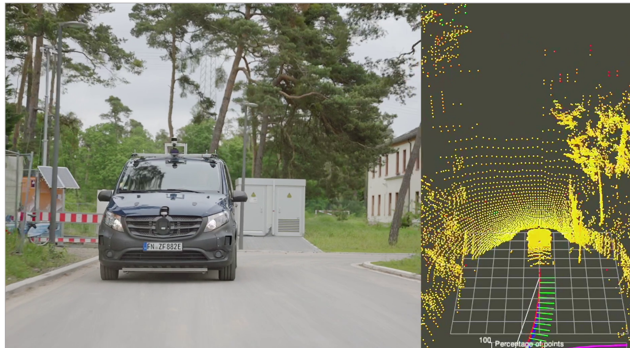
Abbildung 14: Umfeldwahrnehmung der Sensoren
